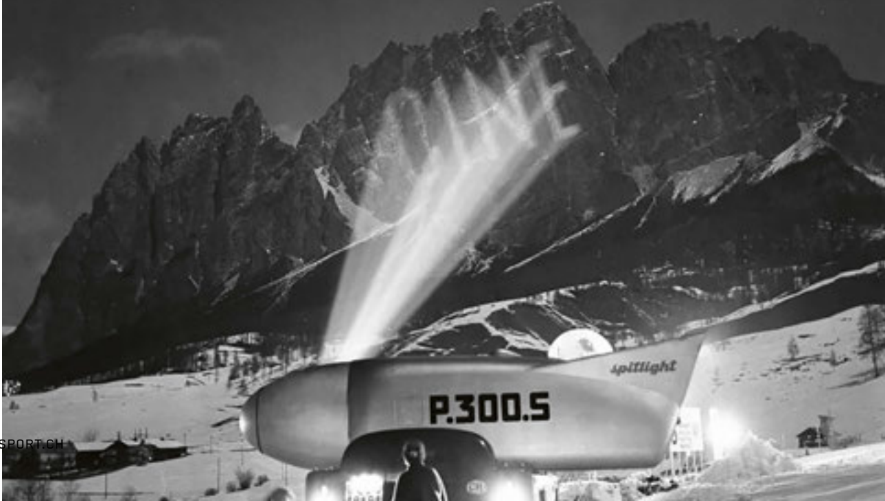
Le Spotlight de l'ingénieur tessinois Gianni Andreoli en 1956 à Cortina d'Ampezzo. Cet appareil, novateur à l'époque, permet de projeter les anneaux olympiques et les noms des champions sur les parois rocheuses du Pomagagnon.
